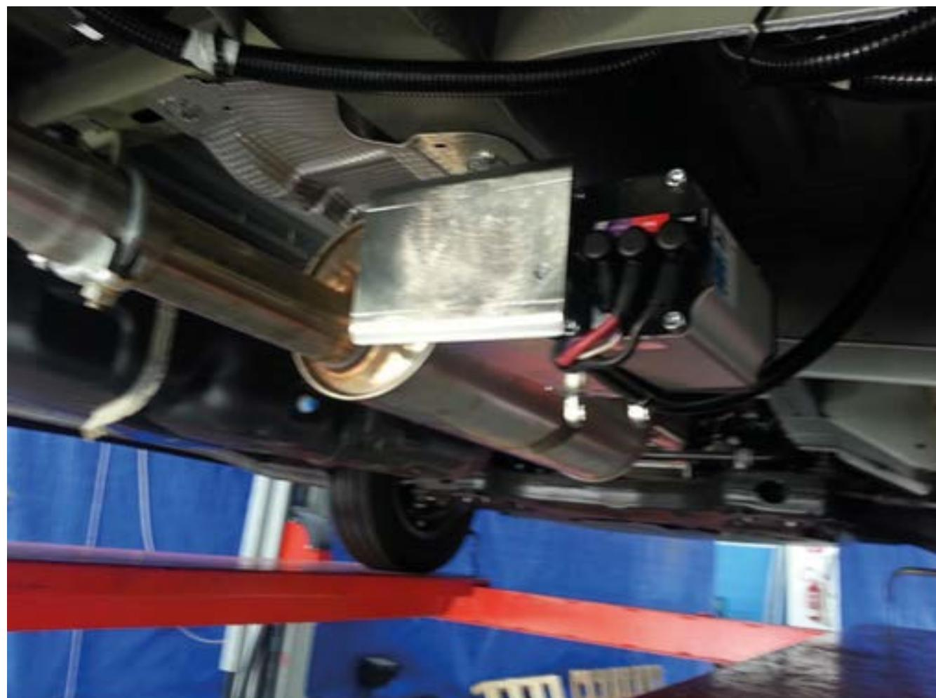
Le moteur du cric avant droit doit être orienté vers l'extérieur, tout en tournant vers l'arrière.
