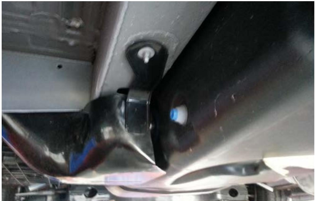
Vasen etuosa: Muokkaa kiinnike (katso seuraava kuva)
