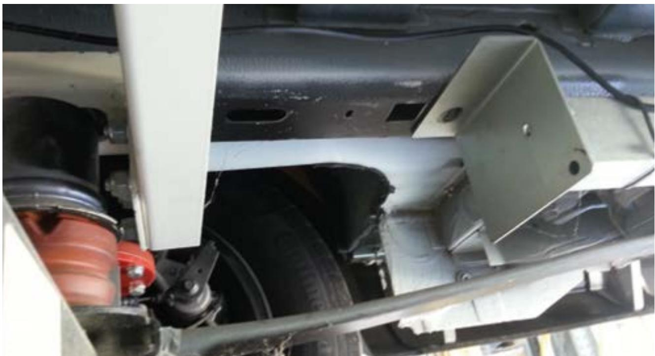
Befestigen Sie die hintere Halterung mit der quadratischen Platte: Stecken Sie die Platte in das Loch und verwenden Sie dann die 12MA-Schraube, um sie zu befestigen (siehe nächstes Foto).
