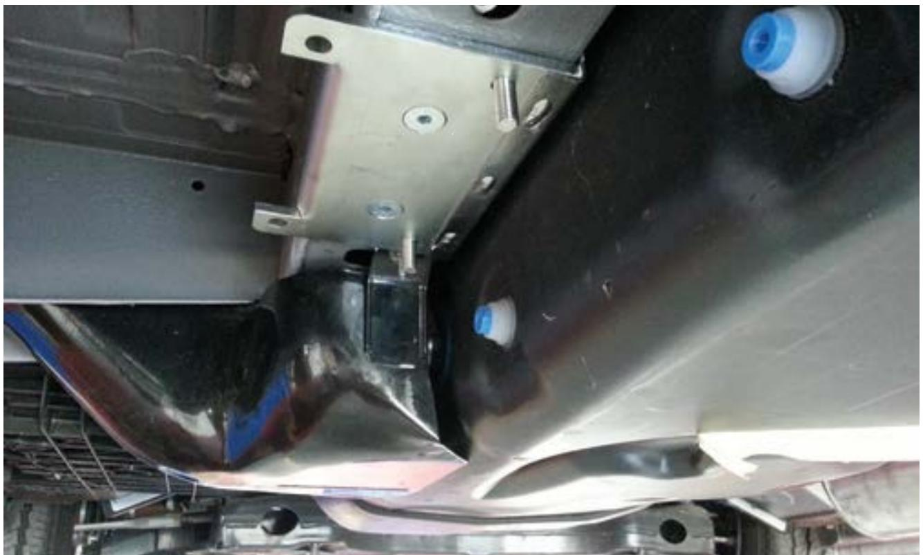
Befestigen Sie die Halterung mit den Schrauben an der Rückplatte am Gehäuse.
