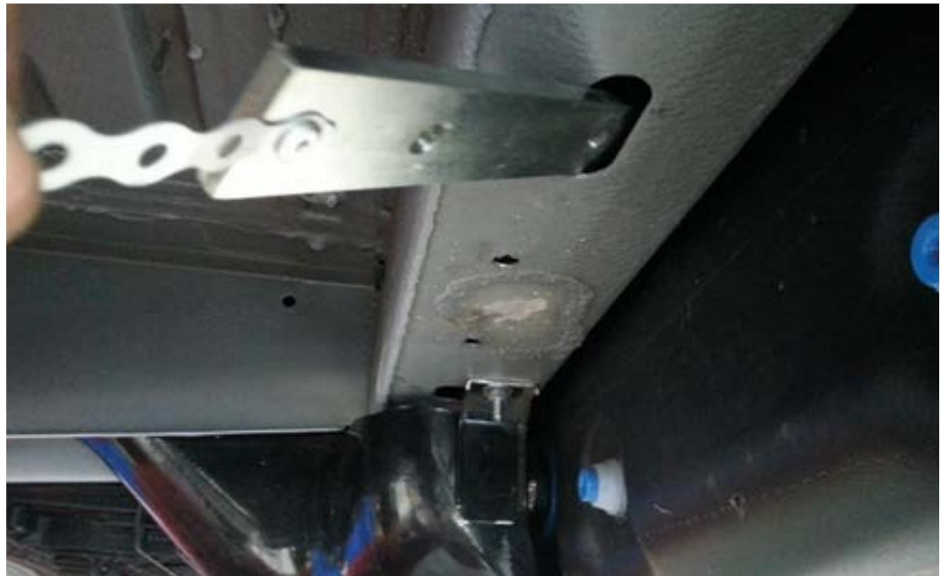
Insérez la plaque arrière de montage dans le trou situé sous le châssis.
