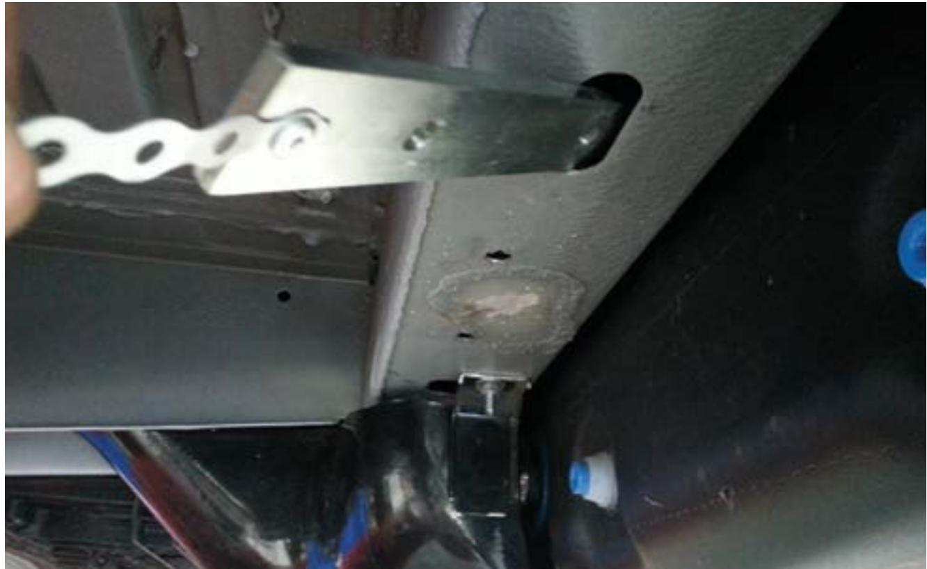
Sätt in monteringsplattan i hålet under chassit.
