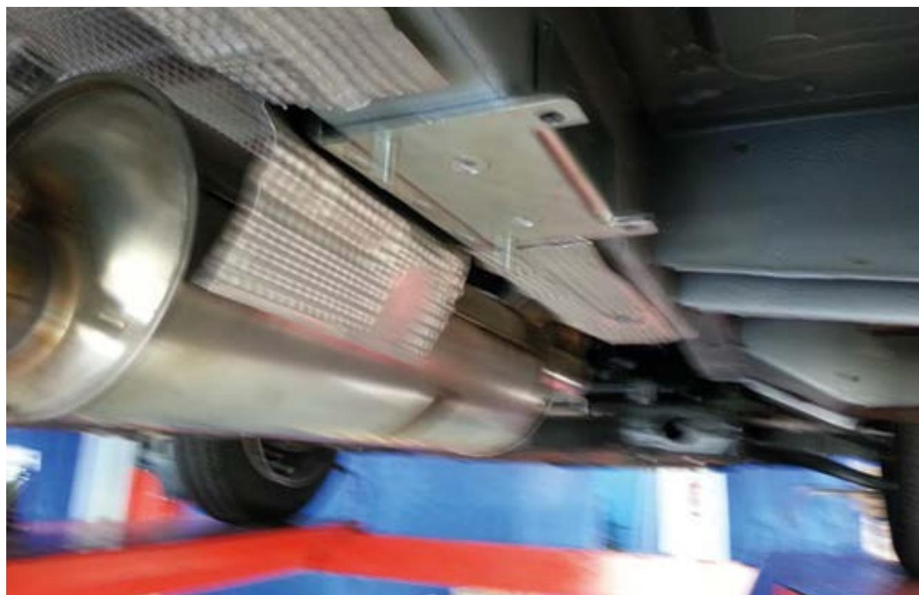
Fixez le support au châssis avec les vis et la plaque de protection (comme fait sur le côté gauche).
