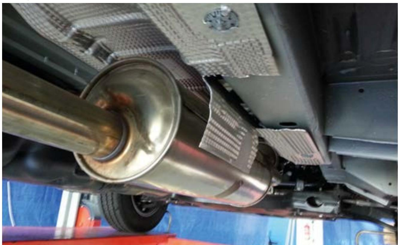
Modificer beskyttelsespladen for at skabe plads til at fastgøre adapteren parallelt med adapteren til venstre.
