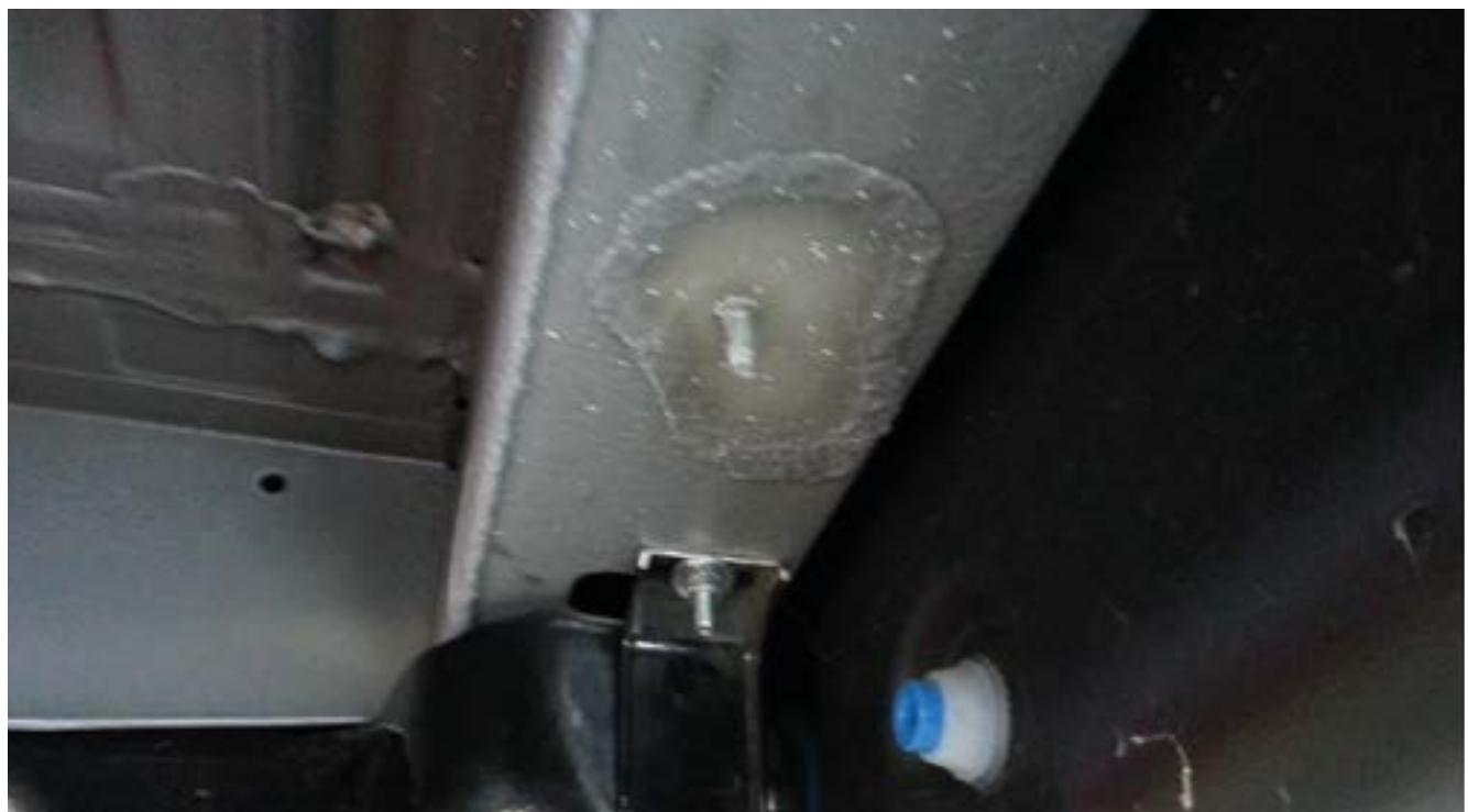
Stecken Sie die Dichtungsplatte in das Loch am Rahmen, setzen Sie den Adapter ein und drücken Sie ihn nach vorne.
