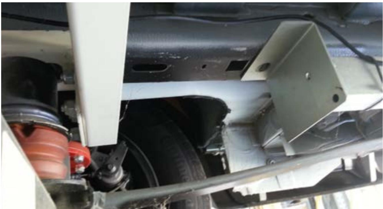
Fäst det bakre fästet med den fyrkantiga bakplattan: sätt in bakplattan i hålet och använd sedan 12MA-skruven för att fästa den (se nästa bild).
