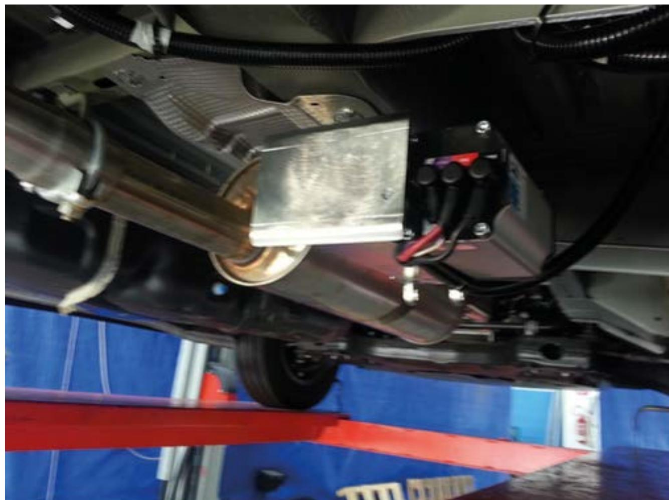
Der Motor des rechten vorderen Wagenhebers muss nach außen zeigen, während er sich nach hinten dreht.
