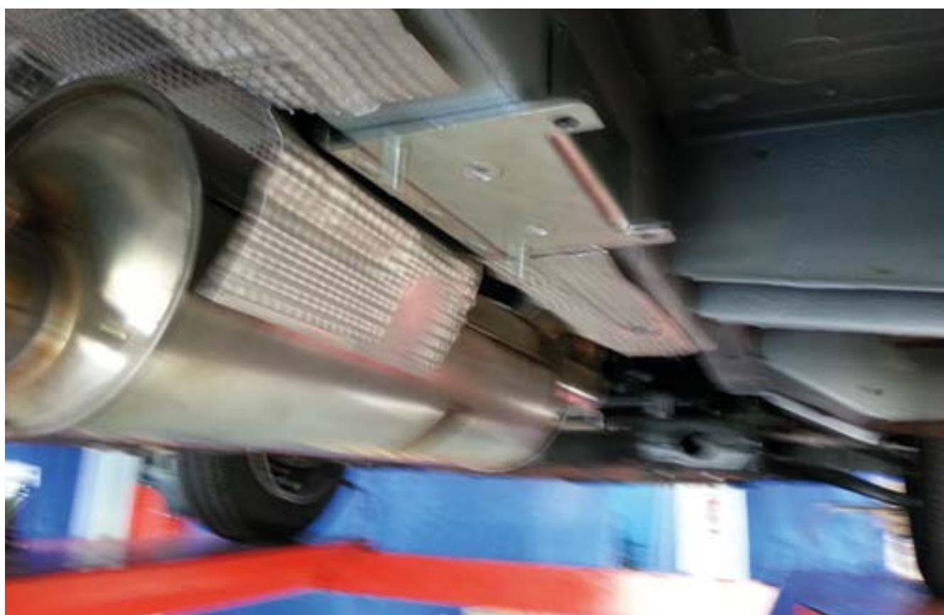
Fije el soporte al chasis con los tornillos y la placa de protección (como se hizo en el lado izquierdo).
