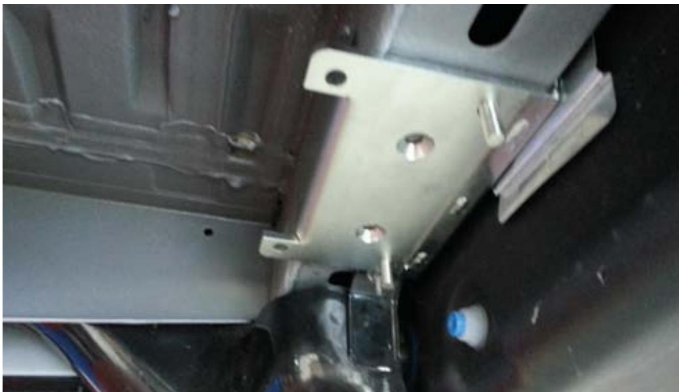
Positionieren Sie die Stütze so weit vorne wie möglich, wie auf dem Foto gezeigt.
