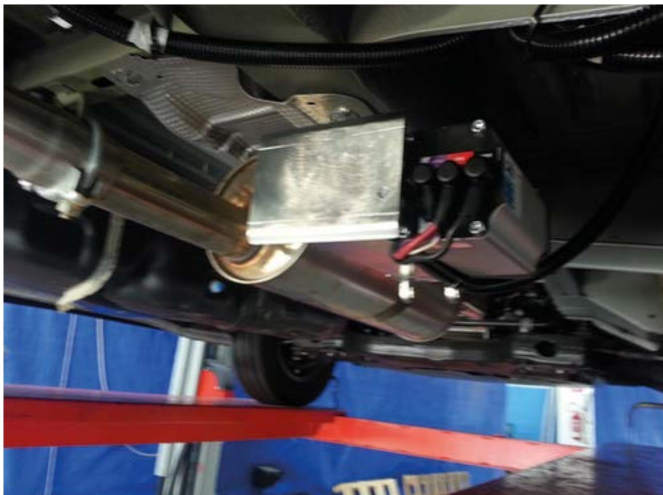
Den forreste højre donkraft skal have motoren vendt udad, mens den skal drejes mod bagdelen.
