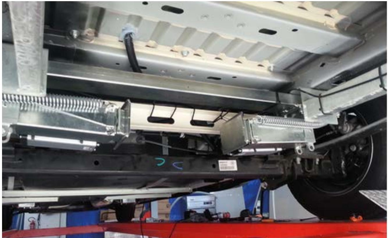
Die Motorheber sollten mit der Vorderseite des Fahrzeugs installiert werden, aber sie müssen zur Mitte hin geklappt werden.
