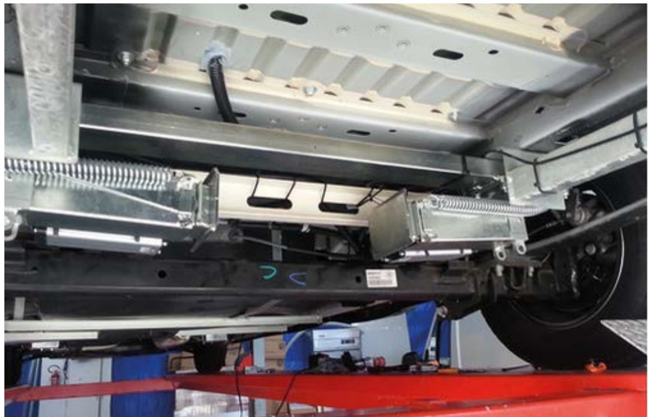
Les crics moteurs doivent être installés face à l'avant du véhicule, mais ils doivent se plier vers le centre.
