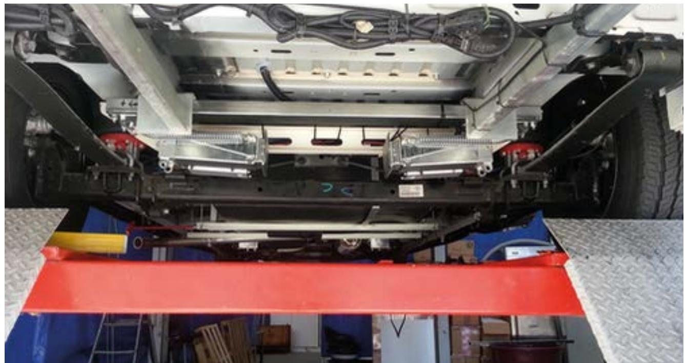
Los gatos del motor deben instalarse mirando hacia la parte delantera del vehículo, pero tienen que plegarse hacia el centro.
