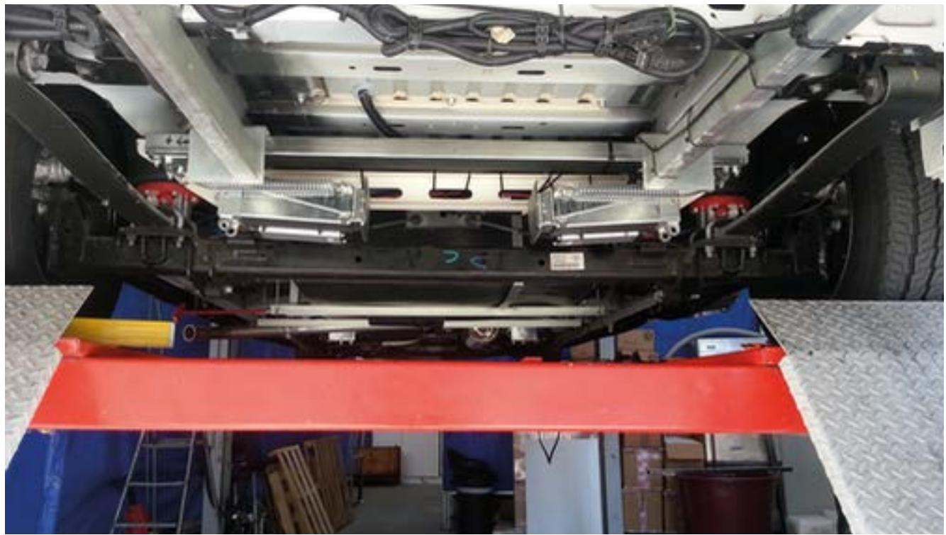
Die Motorheber sollten mit Blick auf die Fahrzeugfront eingebaut werden, müssen aber zur Mitte hin geklappt werden.
