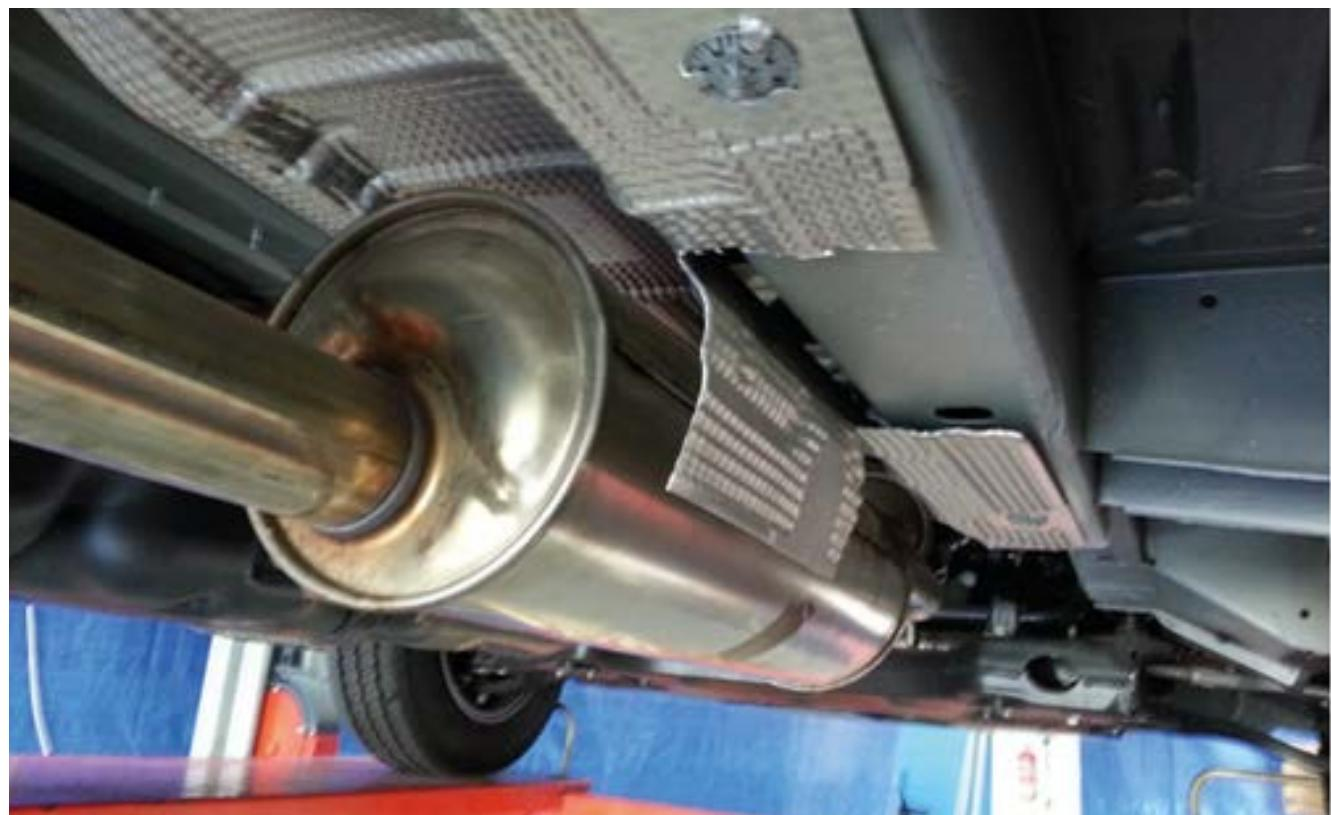
Muokkaa suojalevyä niin, että vasemmalla puolella on tilaa sovittimen kiinnittämiseelle sovittimen kanssa samansuuntaisesti.
