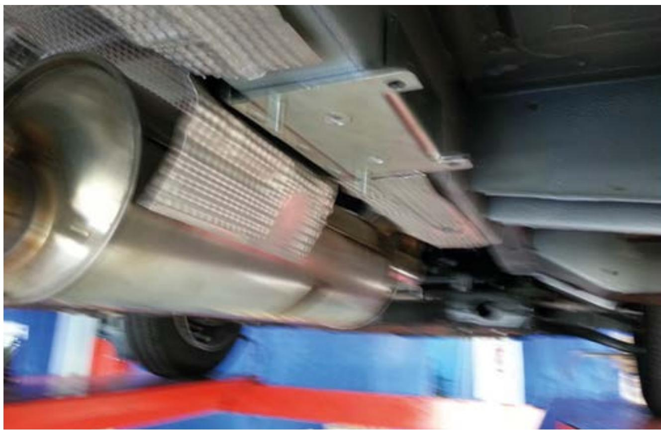
Fäst fästet på chassit med skruvarna och bakplattan (som på vänster sida).
