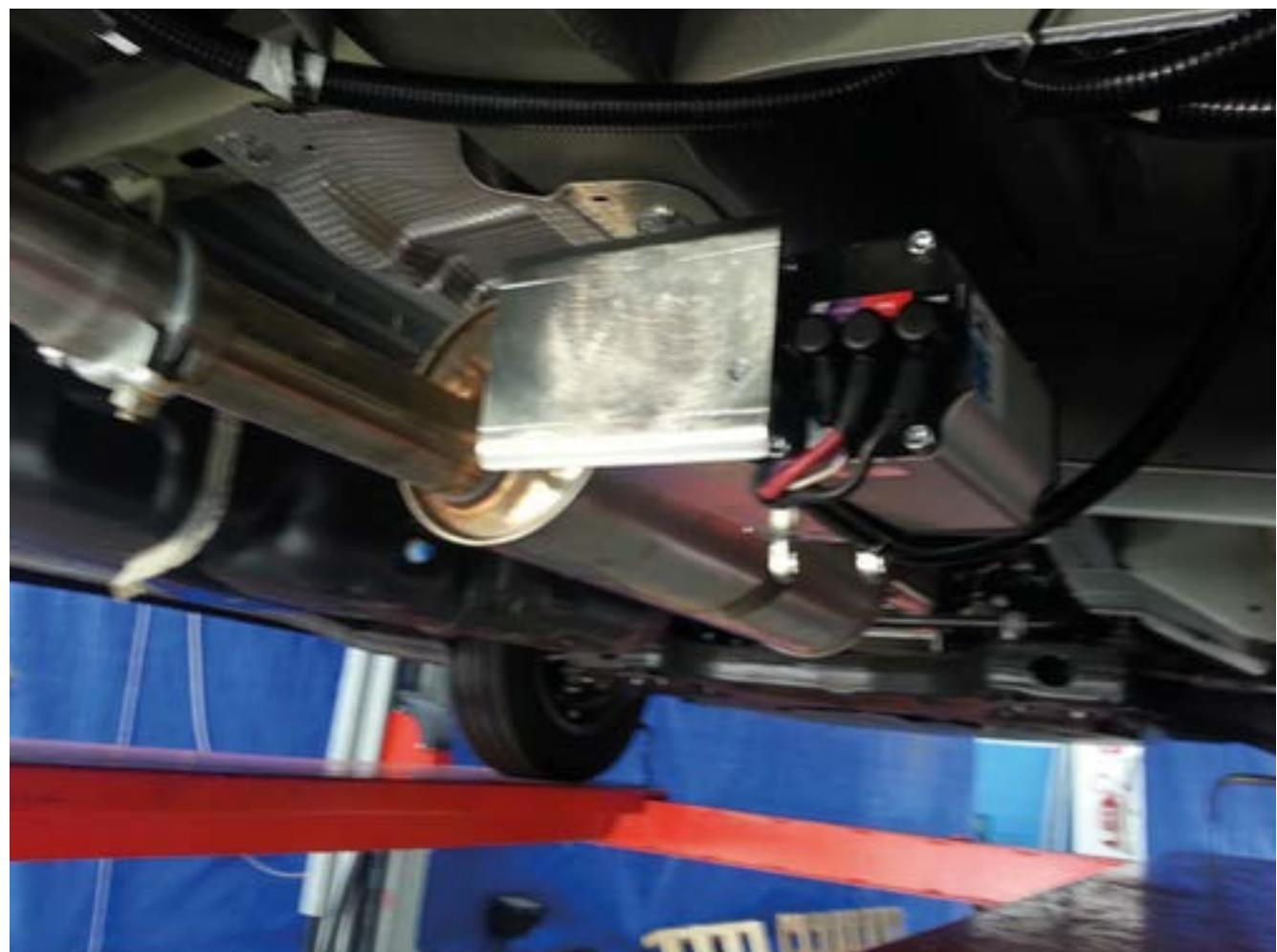
El gato delantero derecho debe tener el motor orientado hacia el exterior, mientras gira hacia la parte trasera.
