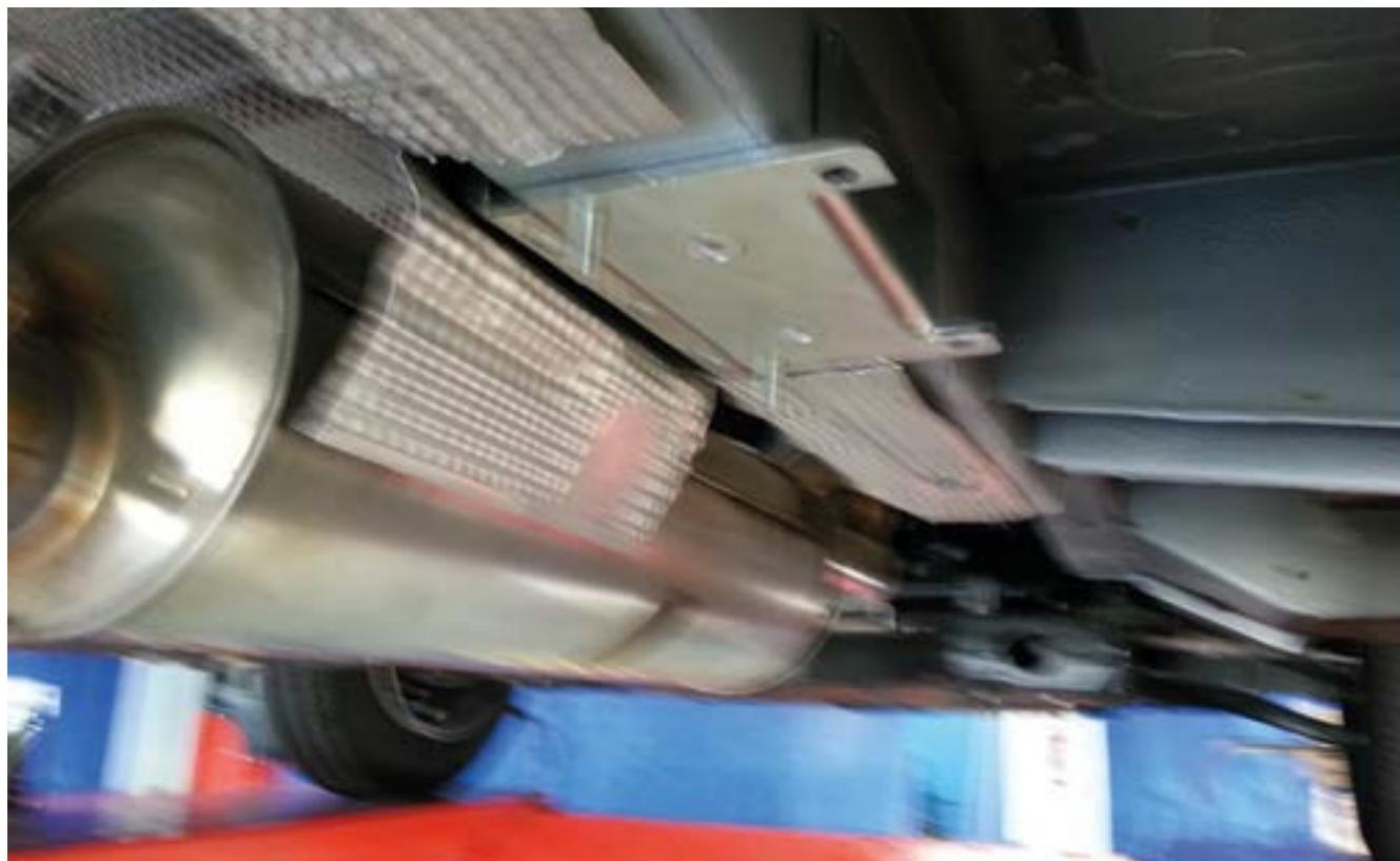
Befestigen Sie die Halterung mit den Schrauben und der Rückwand am Gehäuse (wie auf der linken Seite).
