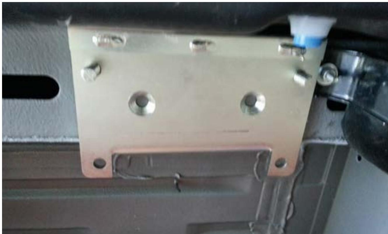
Bohren Sie zwei 10-mm-Löcher entlang der von der Stütze gebildeten Schablone, wie auf dem Foto zu sehen.
