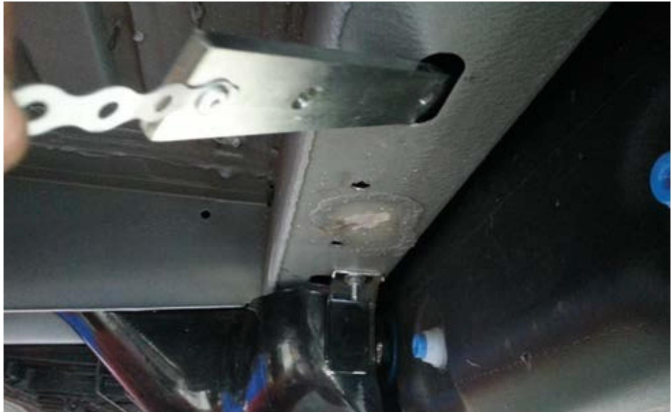
Inserte el soporte de montaje en el agujero bajo el chasis.
