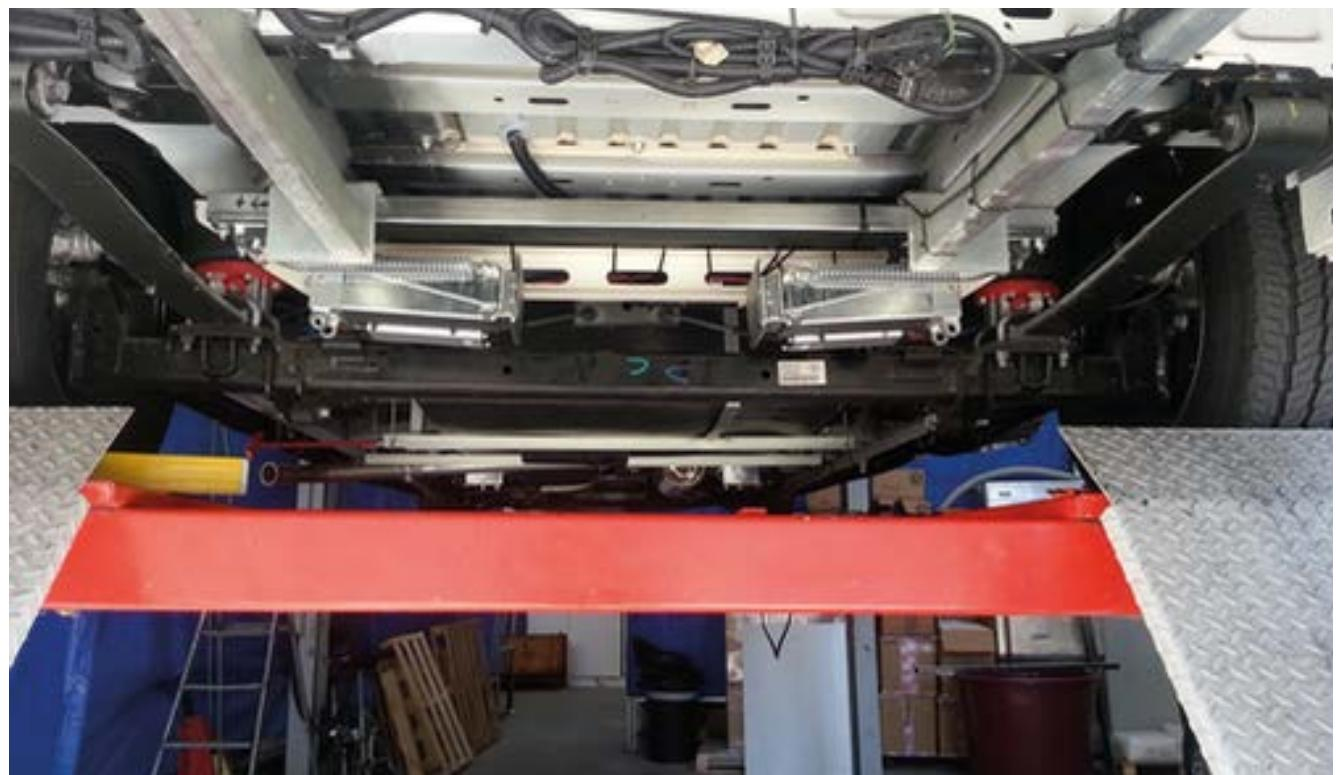
Les vérins du moteur doivent être installés face à l'avant du véhicule, mais ils doivent être pliés vers le centre.
