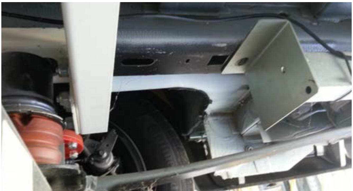
Fixez le support arrière avec la plaque arrière carrée : insérez la plaque arrière dans le trou, puis utilisez le boulon 12MA pour la fixer (voir la photo suivante).
