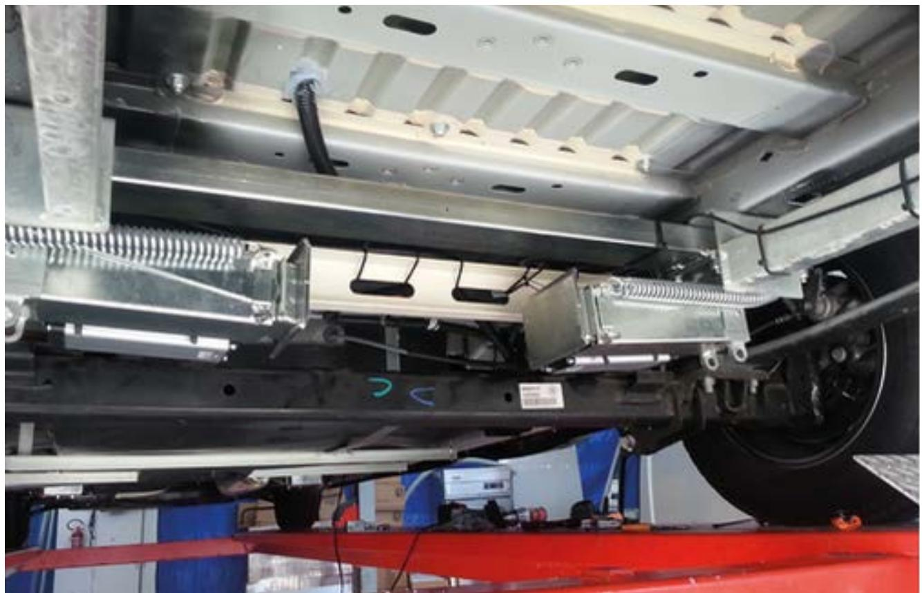
Motorjackorna ska monteras med ansiktet mot fordonets framsida, men de måste fällas in mot mitten.
