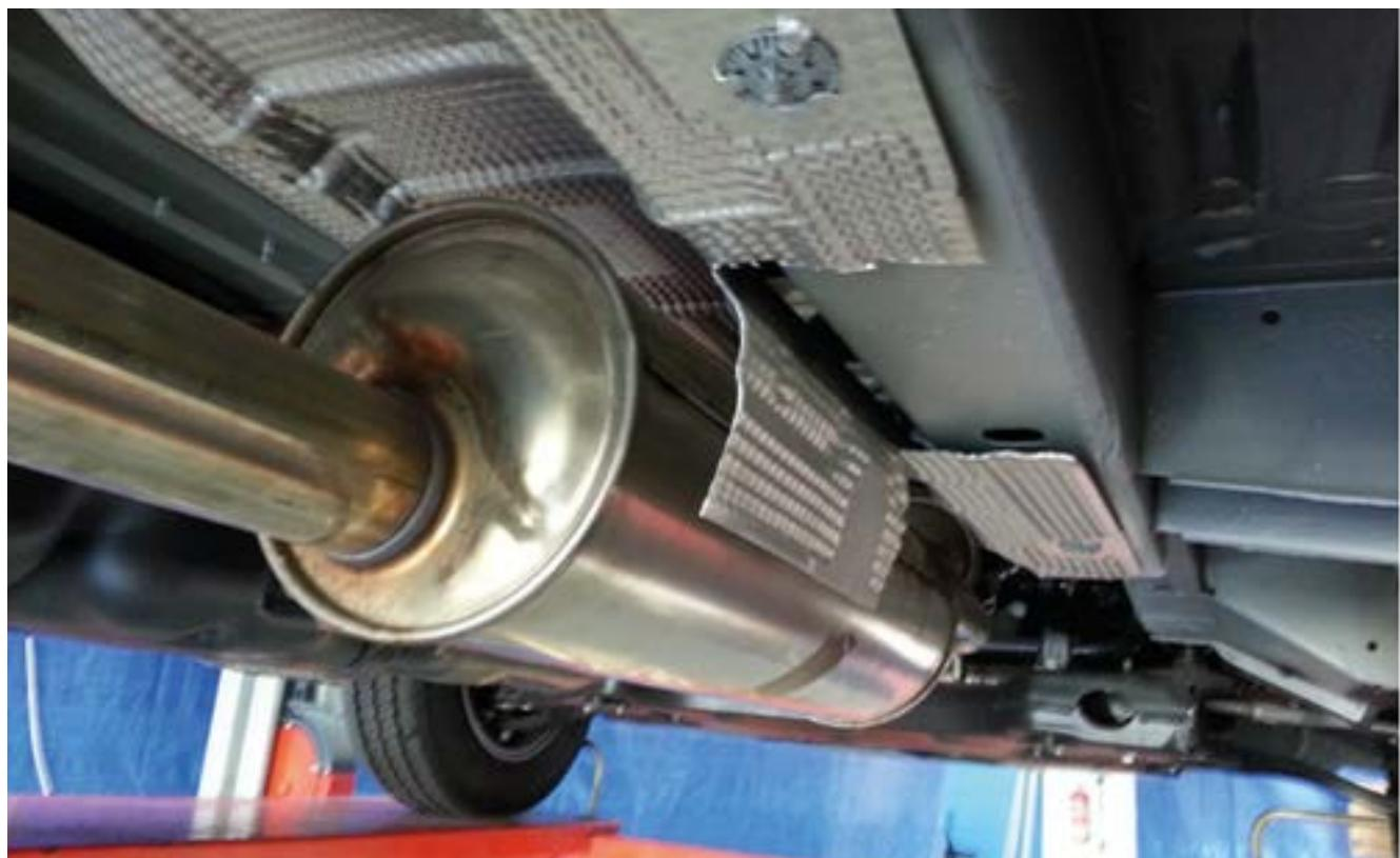
Modificar la placa de protección para crear espacio para fijar el adaptador paralelo al adaptador de la izquierda.
