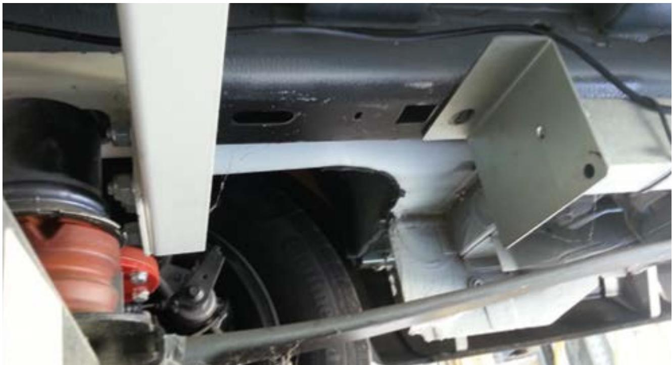
Fastgør det bagste beslag med den firkantede bagplade: Indsæt bagpladen i hullet, og brug derefter 12MA-bolten til at fastgøre den (se næste billede).
