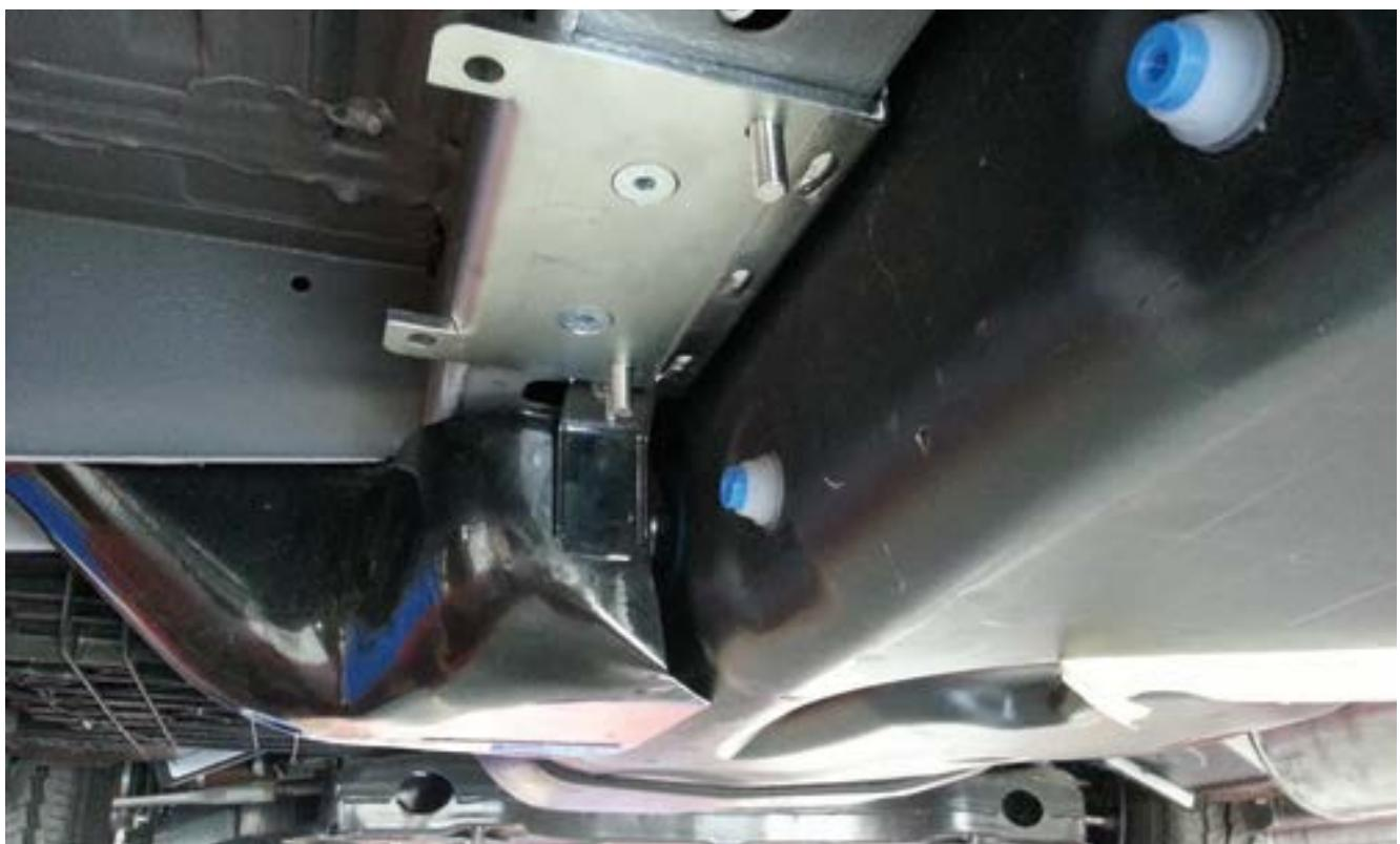
Fäst fästet på chassit med skruvarna till bakplattan.
