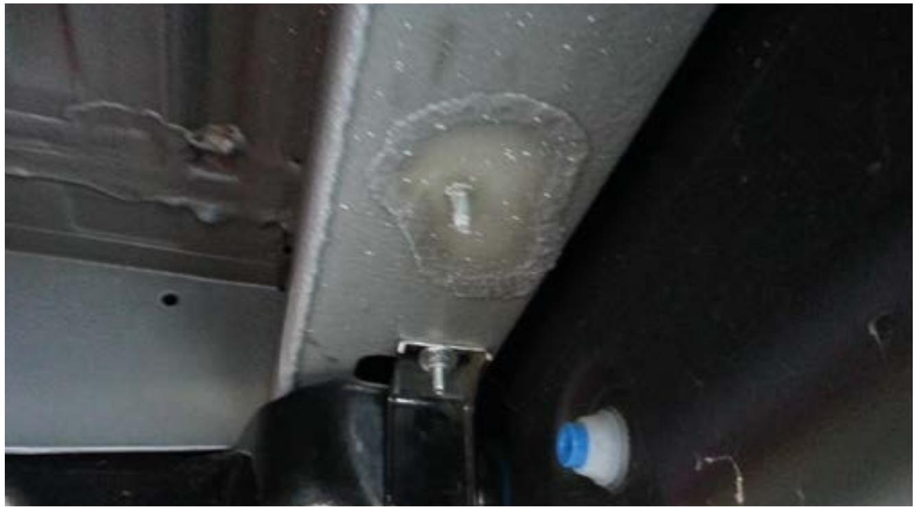
Inserte la placa de sellado en el agujero del marco, coloque el adaptador y empuje hacia el frente.
