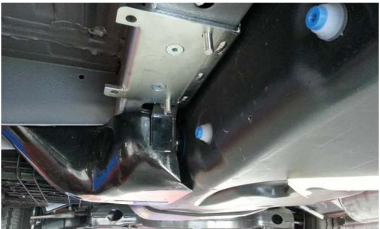
Fixez le support au châssis à l'aide des vis de la plaque arrière.
