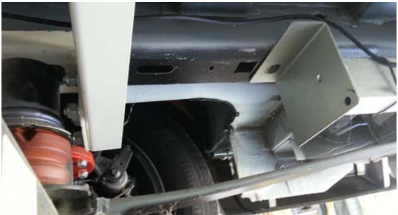
Fissare la staffa posteriore con la piastra posteriore quadrata: inserire la piastra posteriore nel foro, quindi utilizzare il bullone 12MA per fissarla (vedere la foto successiva).
