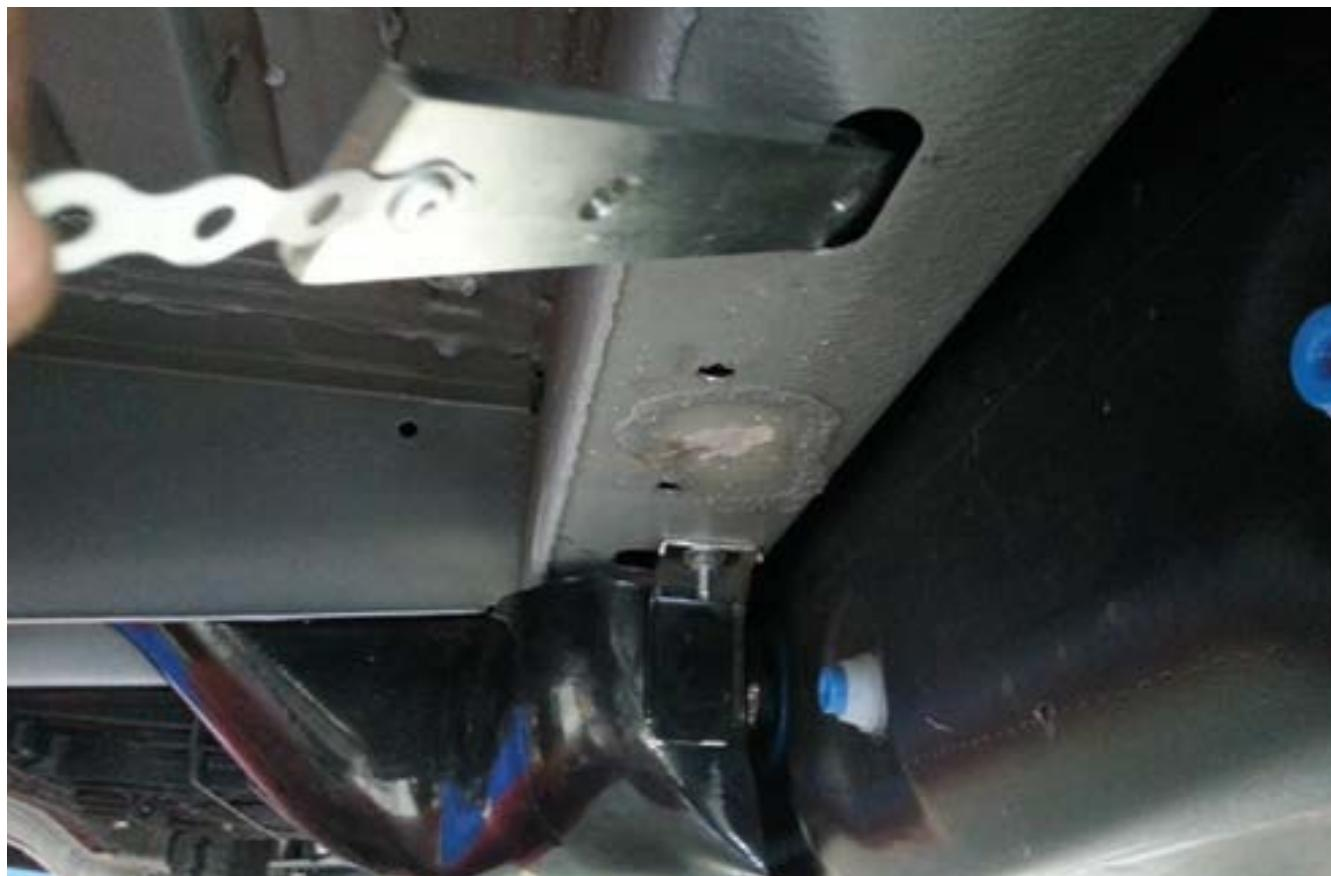
Setzen Sie die Montageplatte in das Loch unter dem Chassis ein.
