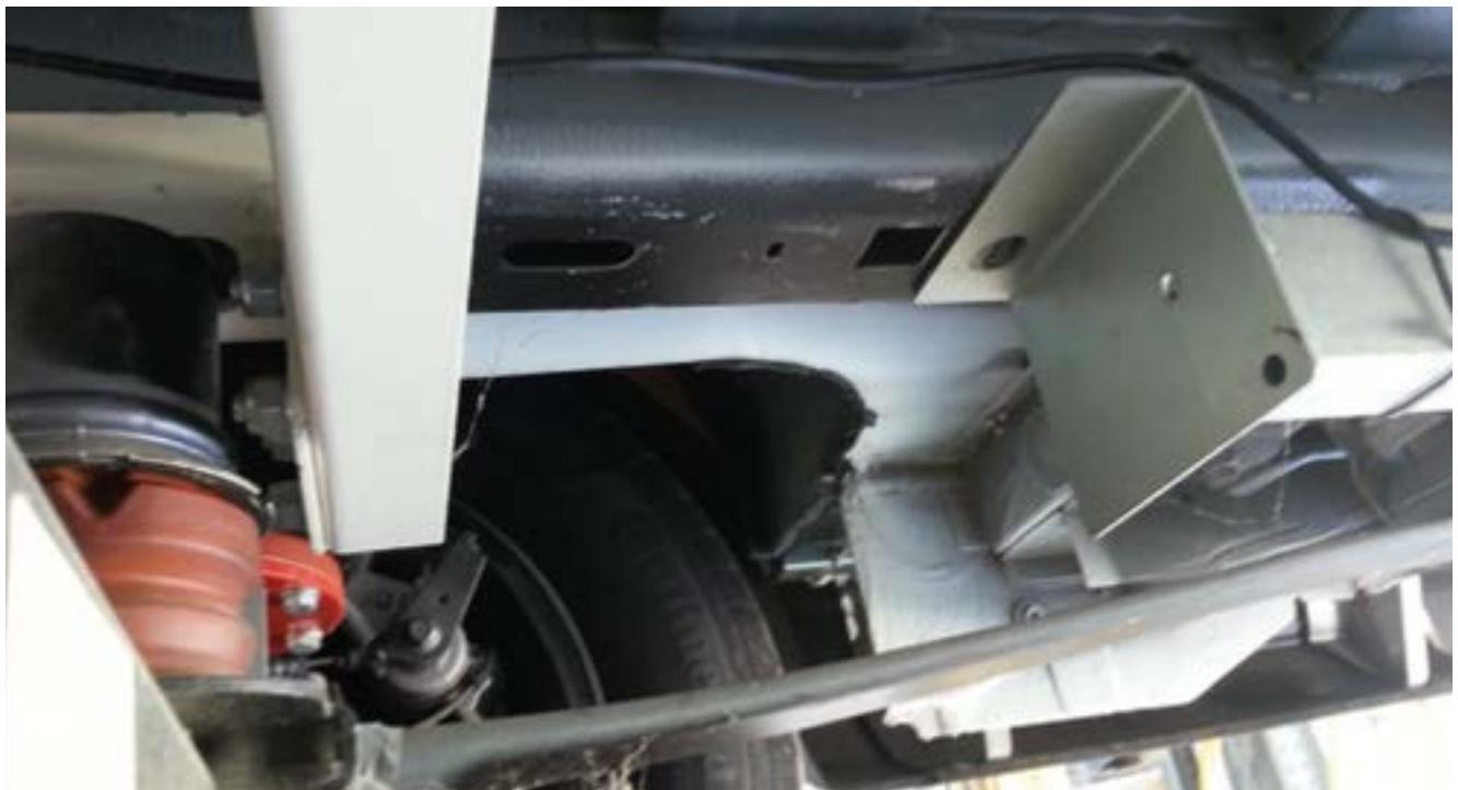
Fije el soporte trasero con la placa trasera cuadrada: inserte la placa trasera en el agujero, y luego utilice el tornillo de 12MA para fijarlo (por favor, vea la siguiente foto).
